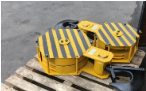
Крюковая подвеска ПК предназначена для подъема и перемещения грузов на металлическом тросе весом от 1,6 тонн и используется на всех типах мостовых и башенных кранов.
