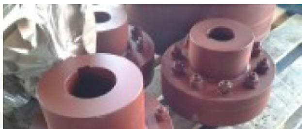
**Муфта зубчатая МЗП** имеет большой крутящий момент в равнении с муфтами МЗ и может надежно обеспечить соединение валов диаметром от 18 до 700 мм.
