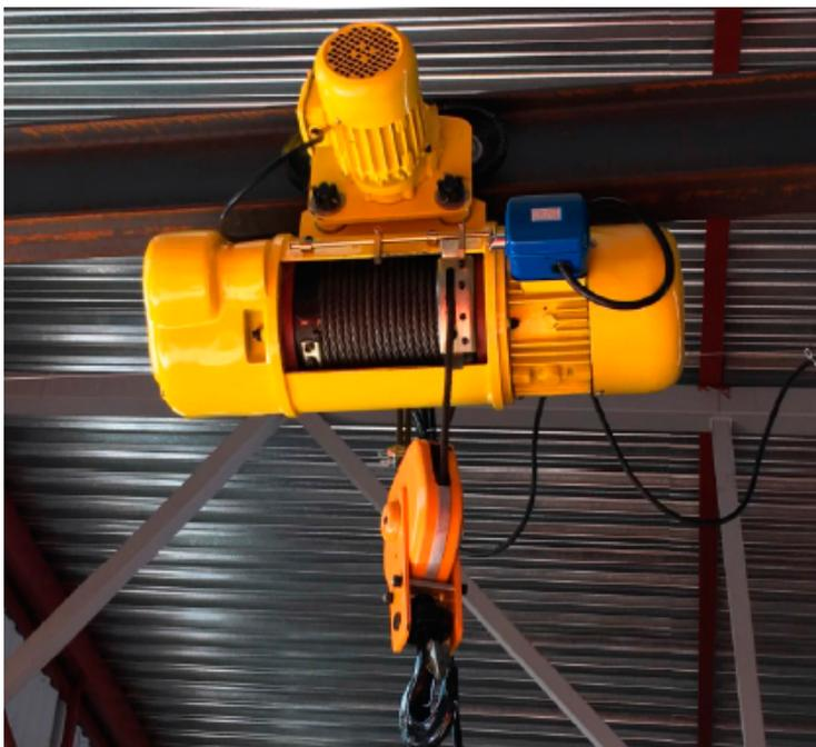
**Электрическая таль** - это современный механизм, предназначенный для вертикального и горизонтального перемещения объектов, на стационарной или подвижной металлической балке.
